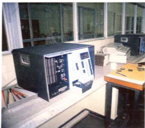
*Equipo automático "InfraAlyzer" utilizado a fines de los 70 para la determinación de Proteína, Materia Grasa y Humedad en Soja.*
