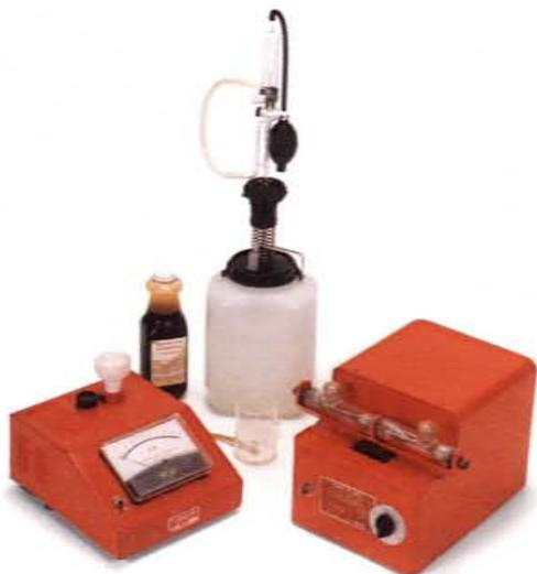
*Equipo utilizado a mediados de los 70 para la determinación de Proteínas en cereales mediante el método Colorímetro.*
